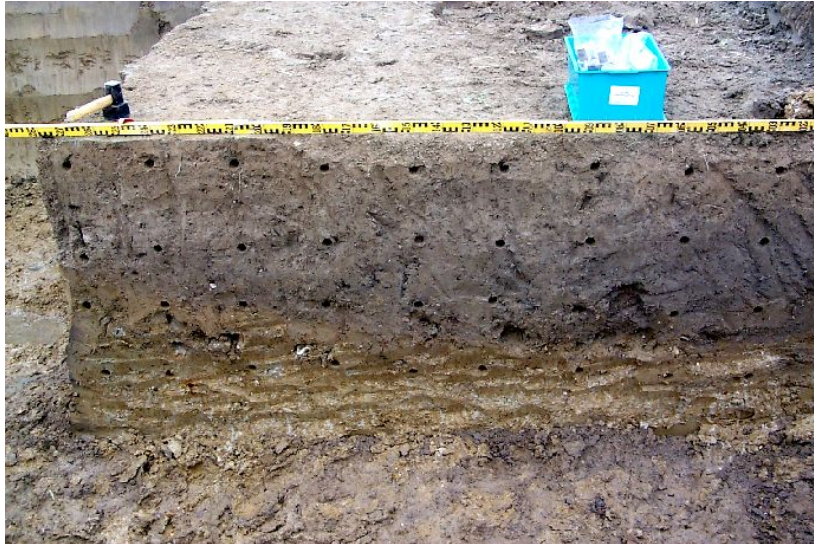
Figur 12.11. Profilet efter prøvetagningen. Bemærk hullerne efter plugning.
