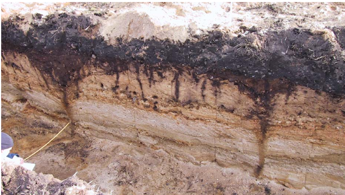
Figur 7. Profil i sandjord som viser de karakteristiske rustfarvede udfældningsniveauer.
