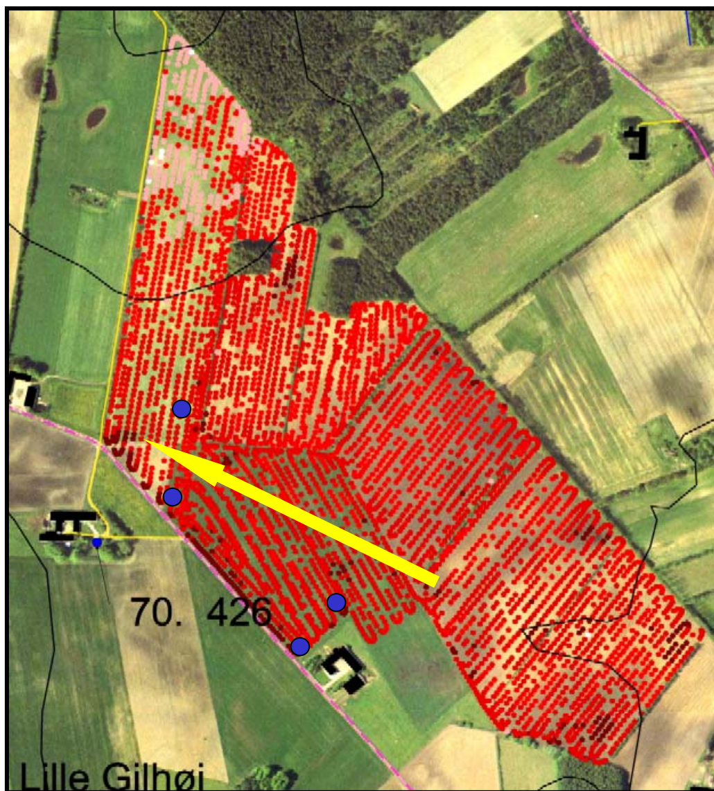
Figur 14.24. Nørager mark. EM38 målinger, boringernes placeringer og grundvandets strømning. retning.
