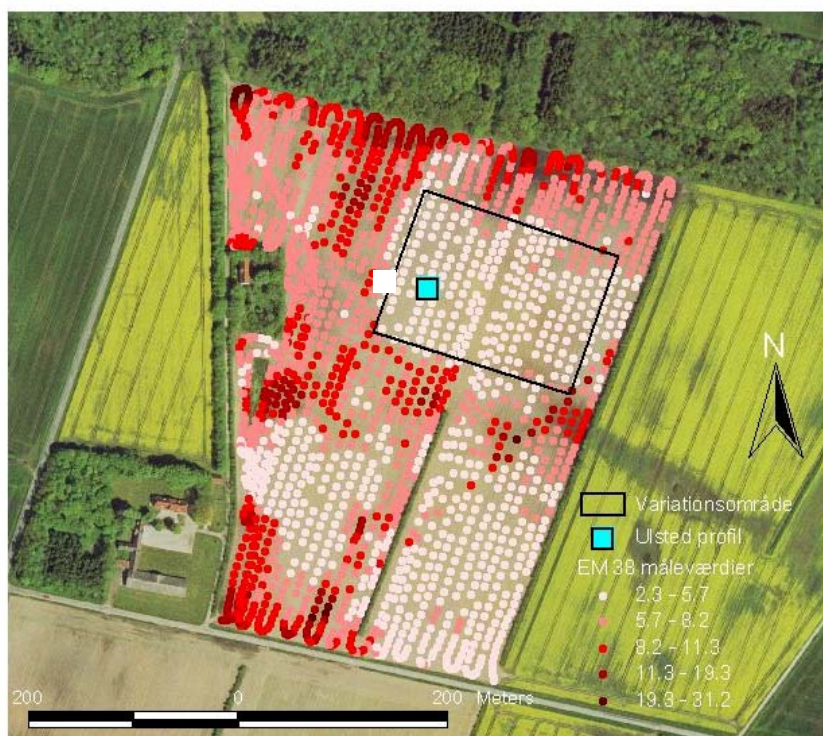
Figur 3A.4. Geoelektriske målinger med EM38 på Yoldiafladen (Ulsted) med angivelse af den udvalgte mark og stedet for fuld profil undersøgelser. Høj elektrisk ledningsevne viser hvor de øvre jordlag er lerede mens lave værdier viser hvor de er sandede.
