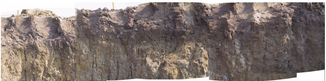
Figur 1.5. Foto af profil fra Gjorslev. Nærbillede af regnormegange og jordstruktur. Fotoudsnippet er ca. 70 cm i dybden og ca. 350 cm i længden.
